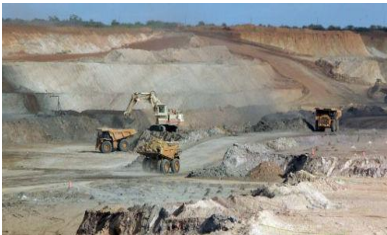
Şəkil 3.2 . Daş kömürün qazma-partlayıcı üsulla çıxarılması
