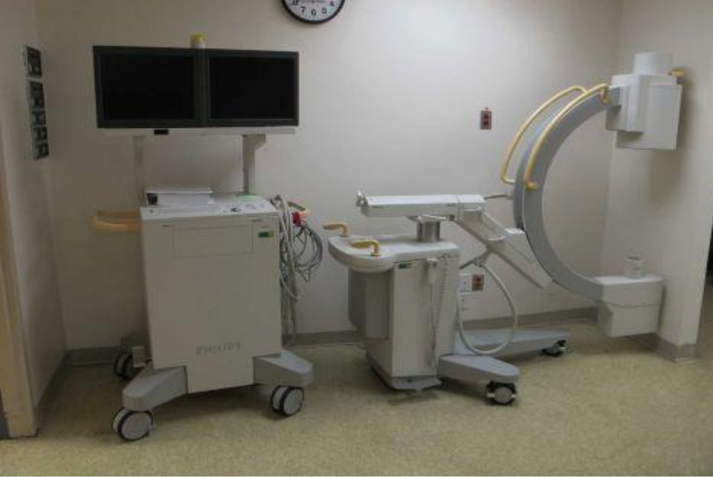
PHILIPS BV Libra mobil rentgen nəzarət aparatı (Hollandiya)
